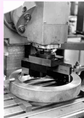
VhNe – elektronická vyvrtávací hlava univerzální (1987) VhNe – electronic universal boring head (1987)
