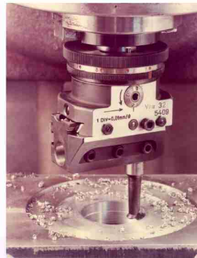
SVN – stavebnice vyvrtávacího nářadí (1977) SVN – modular boring system (1977)
